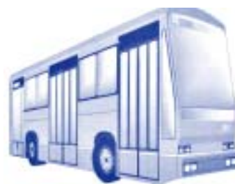
Niederflurbus mit Kneeling und ausfahrbarer Rampe
