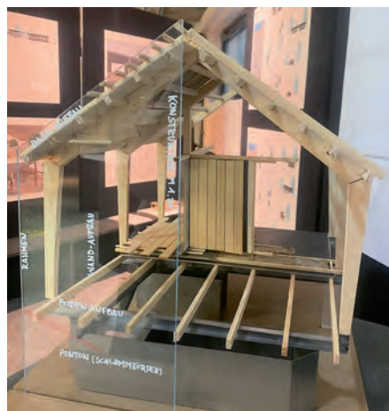
Schnittmodell der Schwimmpontons
