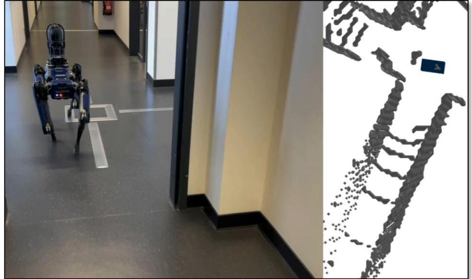
Autonome Aufnahme des Bauwerks und Umgebungs-Scanning durch einen mobilen Roboter (Quelle RUB)
